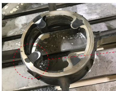
(a) 开裂花键断口
